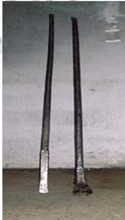
تصویر شماره ۶ : کاستیل کشی، دیلم دستی (از راست به چپ)
